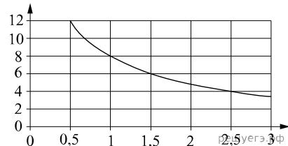
27. Когда самолёт находится в горизонтальном полёте, подъёмная сила, действующая на крылья, зависит от скорости движения. На рисунке изображена эта зависимость для некоторого самолёта. На оси абсцисс откладывается скорость (в километрах в час), на оси ординат — сила (в тоннах силы). Определите по рисунку, чему равна подъёмная сила (в тоннах силы) при скорости 200 км/ч.
